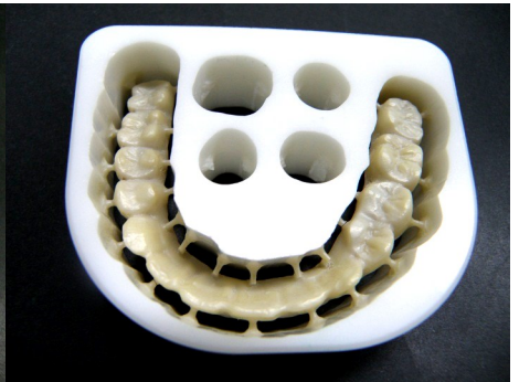
ジルコニアフレーム2段階目の焼結後。 白歯部は咬合面まで削りだされている。
